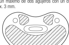
Realice las perforaciones únicamente en las zonas de la placa que aparecen sombreadas en la figura. Mantenga una distancia mínima de ≥ 5 mm con respecto al borde. El fabricante no asume ninguna garantía en caso de taladrar más de dos agujeros o perforaciones con un diámetro de más de 3 mm. Las perforaciones practicadas deben ser desbarbadas para evitar que causen lesiones al usuario.
