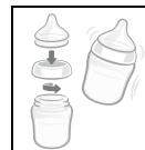
Wird die Muttermilch nicht sofort verwendet, müssen Sie den gefüllten Muttermilchbehälter **11** gut mit der Dichtscheibe **13** und dem Schraubring **15** verschließen und im Kühlschrank aufbewahren oder einfrieren (siehe „9. Aufbewahrung der Milch“ auf Seite 8).
