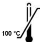
Die verwendeten Flaschen und Gläser müssen temperaturbeständig bis **mindestens 100 °C** sein. Für Flaschen aus Polyethylen (PE) und Muttermilchbeutel ist das Gerät daher nicht geeignet.
